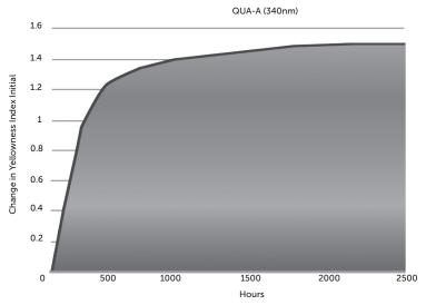
QUV using w 340 bulb, 8 hours 70° C, 4 hours 50° C condensation
